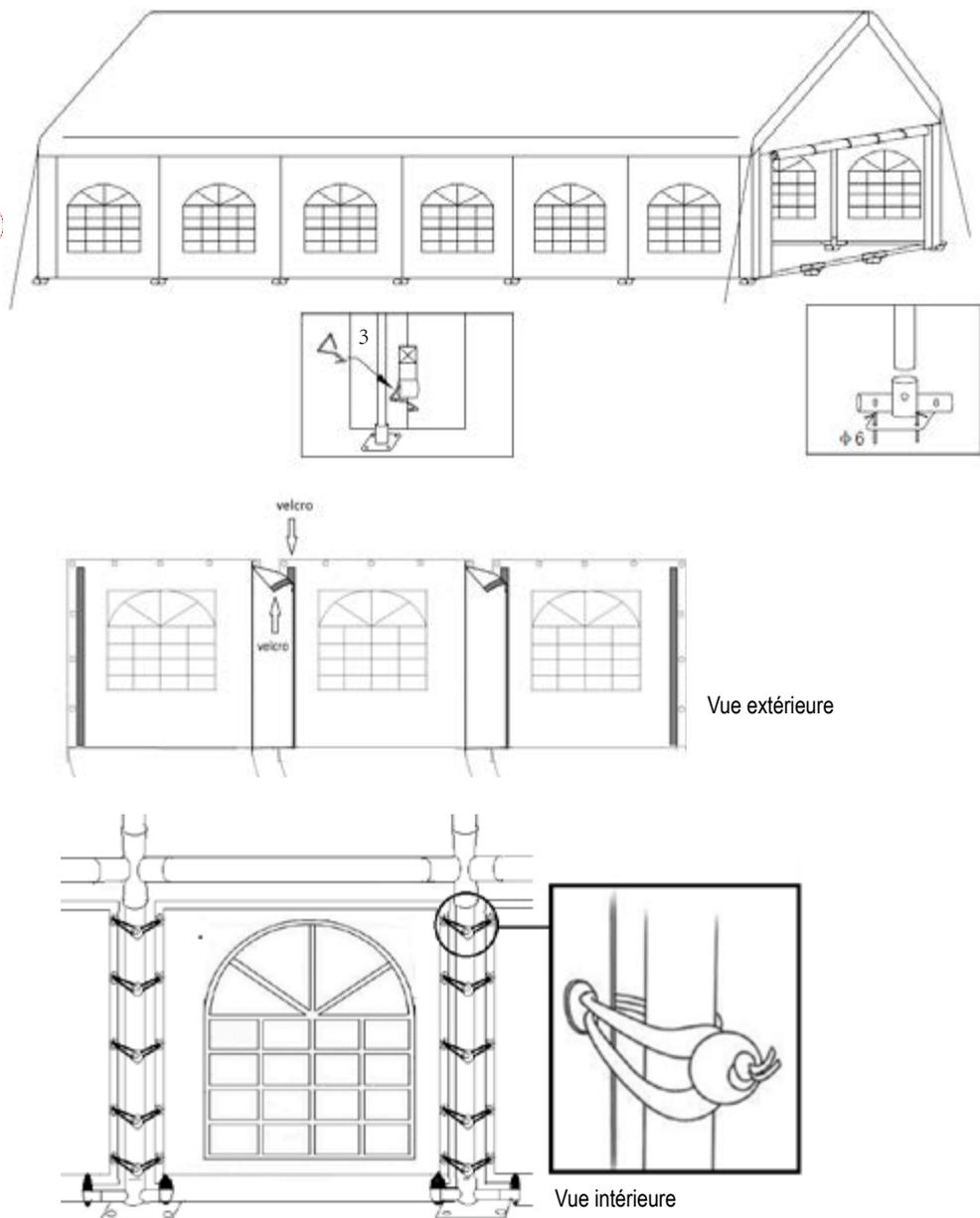
Utilisez les sardines moyennes (6x180mm) pour immobiliser les platines de sol. Dépliez les bâches latérales et les fixer en suivant les schémas explicatifs ci-dessus. Attachez les extrémités du haut directement sur la barre de toit à l'aide des petits élastiques. A l'aide des crochets, fixer les pans du toit aux tubes 3. Utilisez les petites sardines (4x180mm) dans les œillets pour fixer les bâches latérales au sol. Fixez les sangles à l'aide des grandes sardines (8x300mm).
