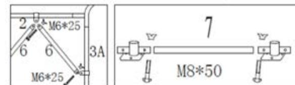
Renforcez la structure aux quatre coins à l'aide des barres de contreventement n°6. Fixer les sur les tubes de 50mm à l'aide des colliers Dia.50 et des vis papillon M6\*25 ainsi que sur les tubes de 76mm à l'aide des colliers Dia.76 et des vis papillon M6\*25.
