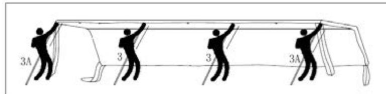
Inclinez l'un des côtés de la structure pour monter les pieds (tubes n°3) dans les jonctions A et B.
